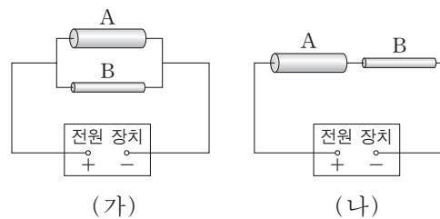
(가), (나)의 합성 저항의 저항값을 각각  $R_{(가)}$ ,  $R_{(나)}$ 라 할 때,  $R_{(가)} : R_{(나)}$ 는? (단, 온도에 따른 저항 변화는 무시한다.)
