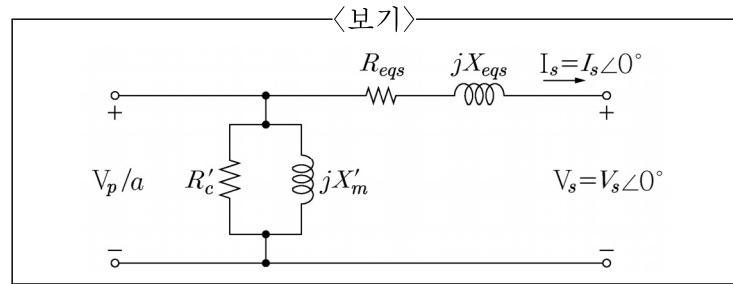
$$\textcircled{1} \quad \frac{\sqrt{(V_s + R_{eqs}I_s)^2 + (X_{eqs}I_s)^2} - V_s}{V_s} \times 100$$
