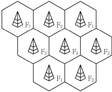
하나의 기지국이 감당할 수 있는 최대 통화량은 일정하다. 평지에서 기지국이 전파를 발사하면 전파의 장은 기지국을 중심으로 한 원 모양이지만, 서비스 지역에 셀을 배치하는 시스템 설계자는 해당 지역을 육각형의 셀로 디자인하여 중심에 기지국을 배치한다. 기지국의 전파 강도를 조절하여 셀의 반지름을 반으로 줄이면 면적은 약 1/4로 줄어들게 된다. 따라서 셀의 반지름을 반으로 줄일 경우 동일한 지역에는 셀의 수가 약 4배가 되고, 수용 가능한 통화량도 약 4배로 증가하게 된다. 이를 이용하여 시스템 설계자는 평소 통화량이 많은 곳은 셀의 반지름을 줄이고 통화량이 적은 곳은 셀의 반지름을 늘려 서비스 효율성을 높인다.
