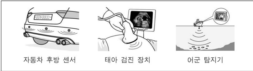
자동차 후방 센서      태아 검진 장치      어군 탐지기
