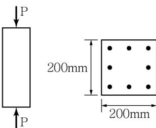
$$A_{st}=2,000\text{mm}^2, \text{ 철근과 콘크리트의 탄성계수비 } n = \frac{E_s}{E_c} = 8,$$
