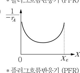
19. 어떤 액상반응에 대한 반응속도의 역수  $1/-r_A$ 를 반응물의 농도  $C_A$ 에 대해서 그린 그래프가 아래와 같다. 2개의 반응기(플러그흐름반응기(PFR) 또는 혼합흐름반응기(CSTR)) 또는 혼합흐름반응기(CSTR)를 적절히 사용함으로써 A의 농도를 초기농도  $C_{A0}$ 에서 최종농도  $C_{Af}$ 까지 반응시키려 한다. 가장 적합한 방법은 무엇인가?
